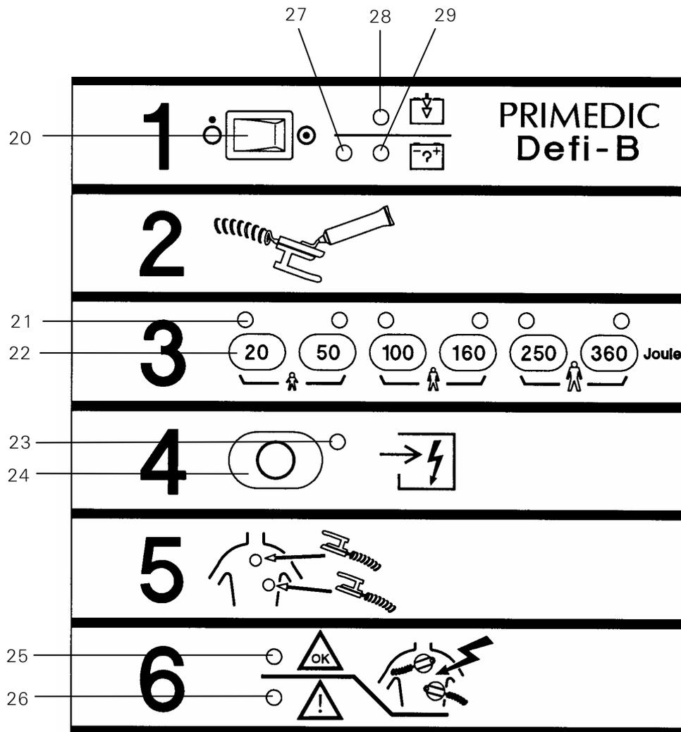
**Fig.: 2 Unità defibrillatore con elementi di comando e display**
