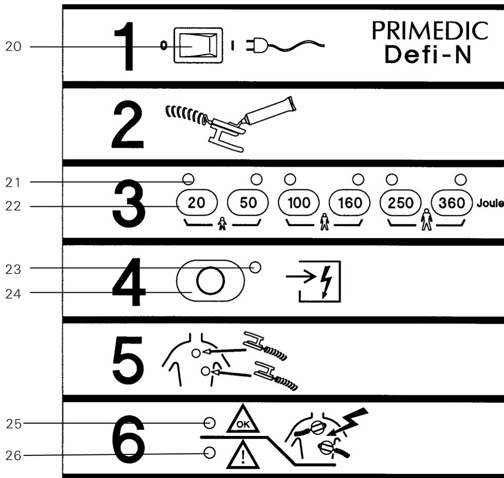
**Fig.: 2 Unità defibrillatore con elementi di comando e display**
